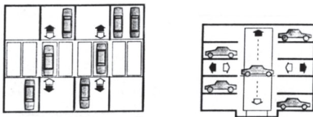
تصویر ۷-۴- استفاده از باربر ثابت به صورت عمود بر مسیر اصلی (ابوتراب و جعفری نژاد، ۱۳۷۳: ۵)
