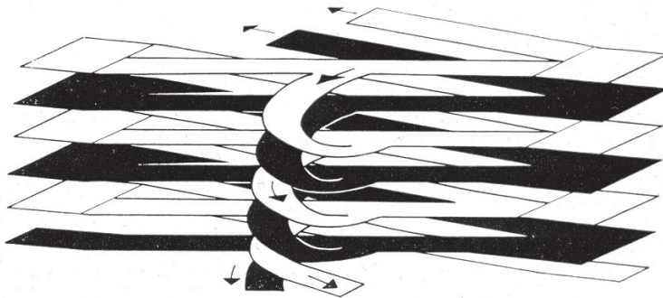
تصویر ۳-۶- پارکینگ شیب‌دار با رمپ خروجی مجزا در وسط (Büttner, 1967: 121)
